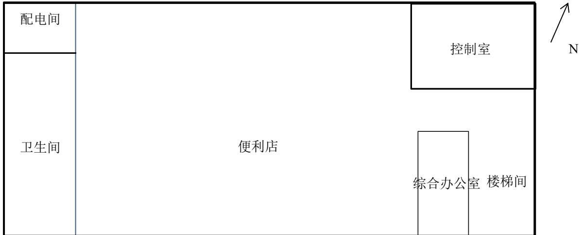
图 2-8 站房一层平面布置简图
