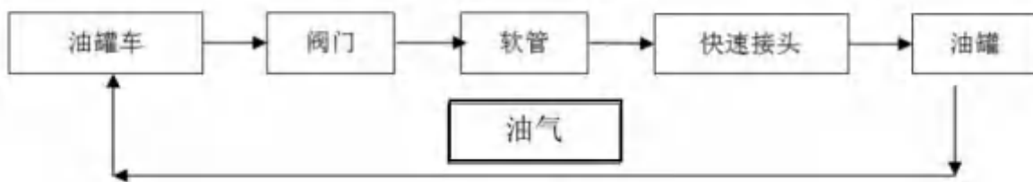
图2.4-1 乙醇汽油卸油工艺流程框图
