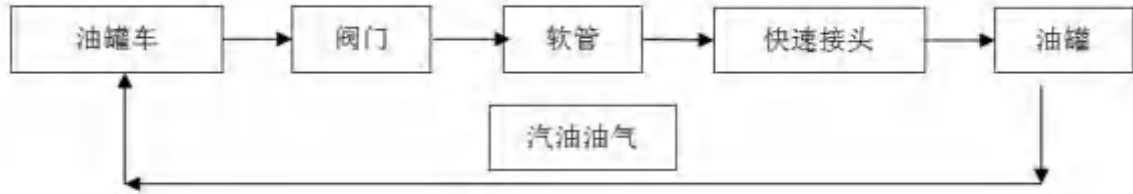
图2.4-1 乙醇汽油卸油工艺流程框图
