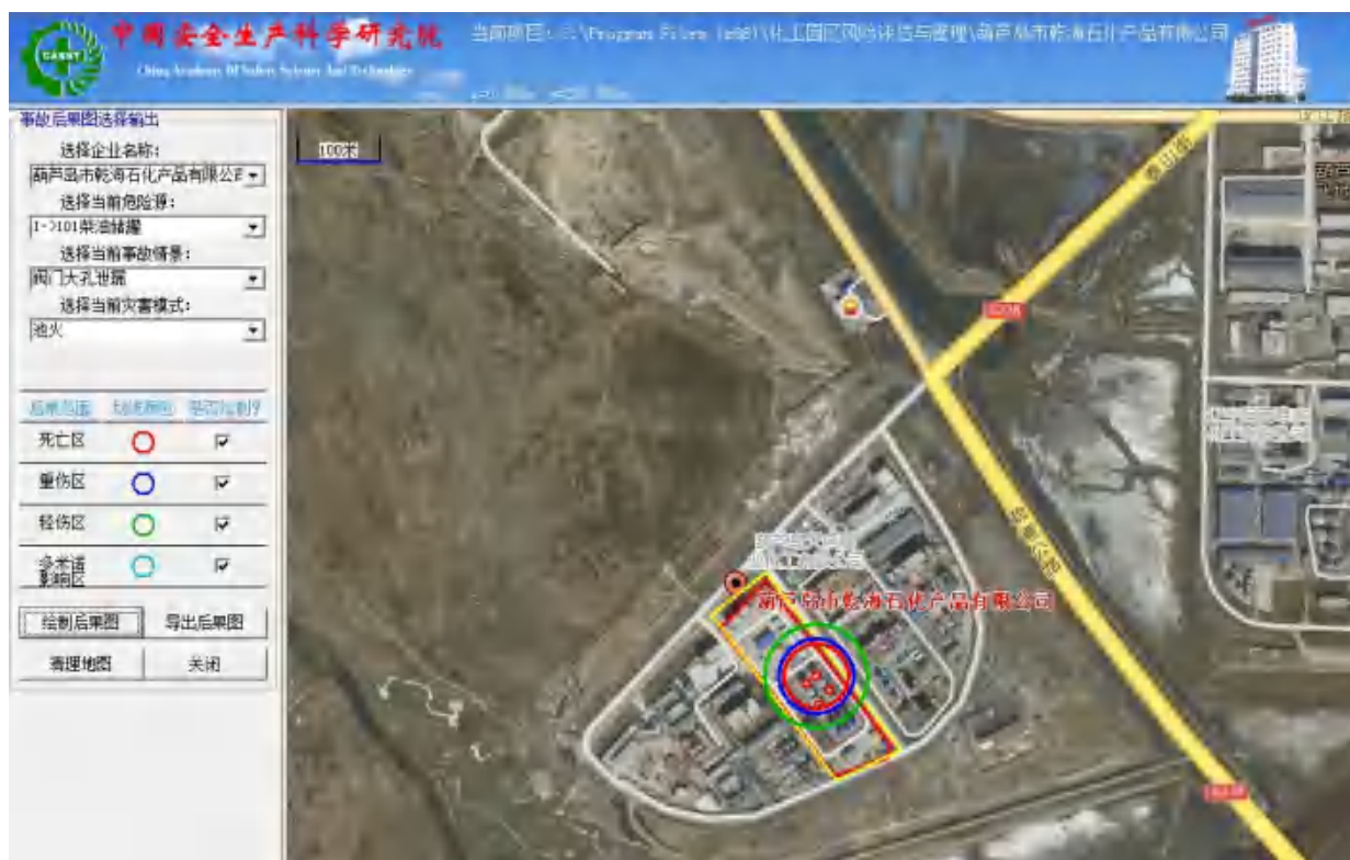
图 4.4-4 柴油储罐阀门大孔泄漏池火灾事故后果图
